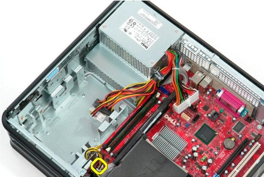
6. Lösen Sie die Prozessorstromkabel aus ihren Kabelführungen.
