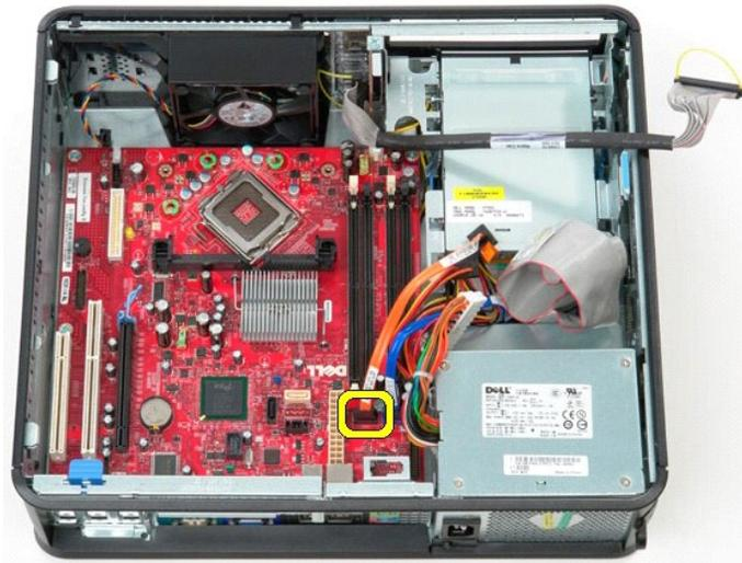
11. Trennen Sie das Datenkabel der Festplatte von der Systemplatine.
