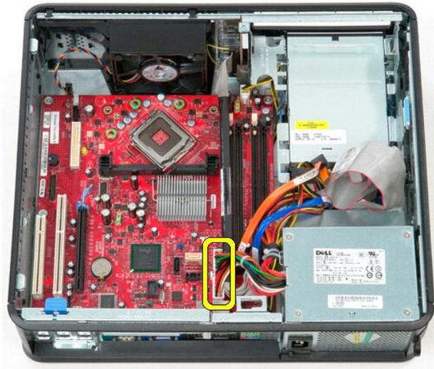
9. Trennen Sie das Kabel der E/A-Leiste von der Systemplatine.
