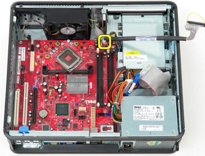
13. Entfernen Sie die Schrauben, mit denen die Systemplatine am Computergehäuse befestigt ist.
