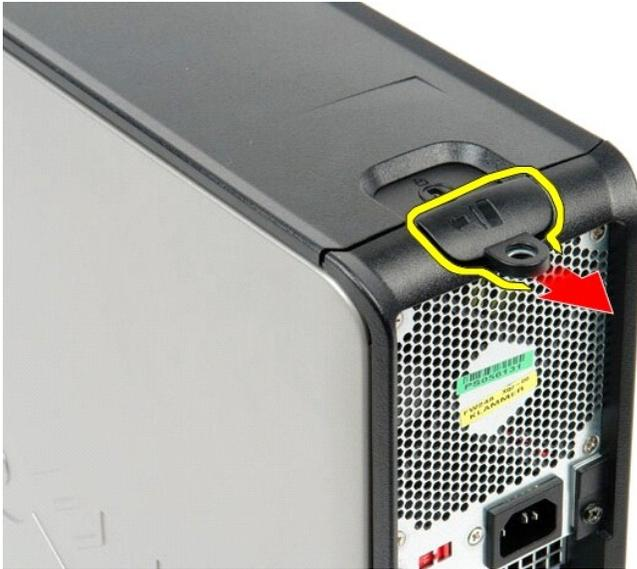
3. Kippen Sie die Computerabdeckung von oben ab und entfernen Sie sie vom Computer.
