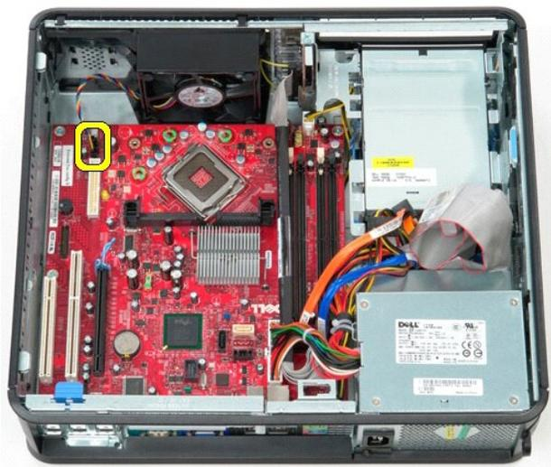
8. Trennen Sie das Haupt-Stromversorgungskabel von der Systemplatine.
