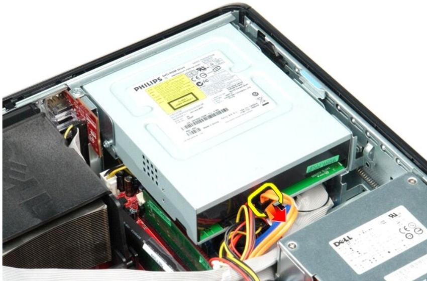
3. Trennen Sie das Stromkabel des optischen Laufwerks.
