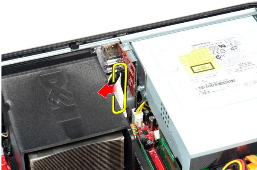
3. Entfernen Sie die Schraube, mit der die E/A-Leiste am Gehäuse befestigt ist.
