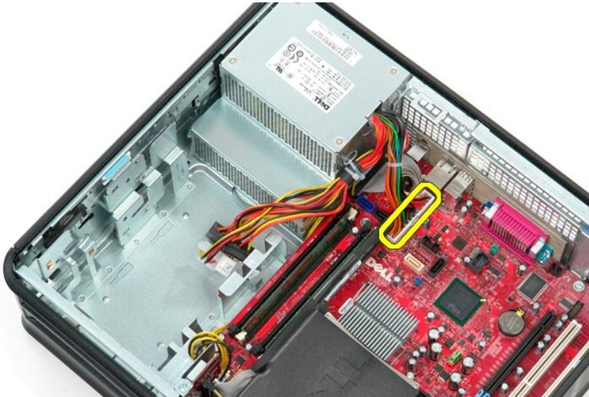
5. Trennen Sie den Anschluss für die Prozessorstromversorgung von der Systemplatine.
