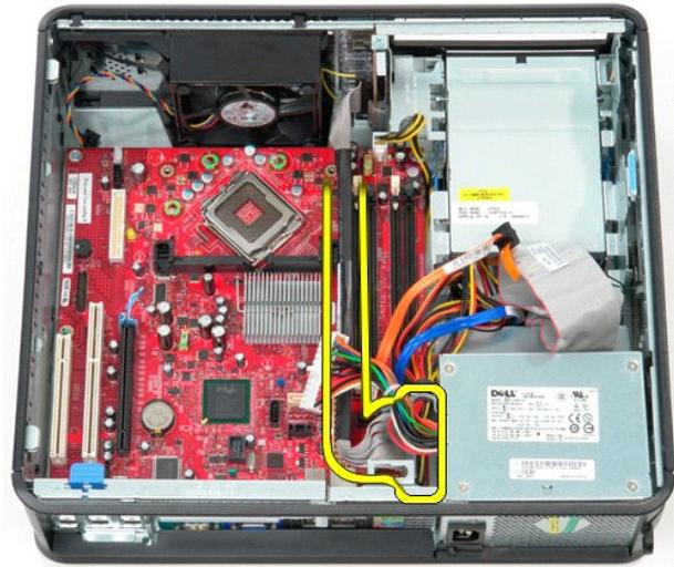
10. Trennen Sie das Datenkabel für das optische Laufwerk von der Systemplatine.
