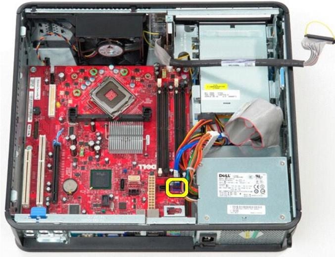
12. Trennen Sie das Stromkabel des Prozessors von der Systemplatine.
